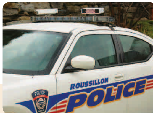
Caméras du système de reconnaissance de plaque d'immatriculation
